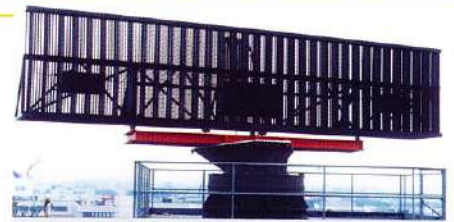
Il radar secondario di sorveglianza AMS SIR
